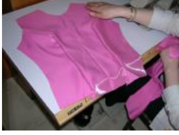
Resim2.1.1.2:Teyel ile birleştirme
